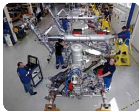
Assemblage de trains principal et central d'Airbus A340 (document remis).
